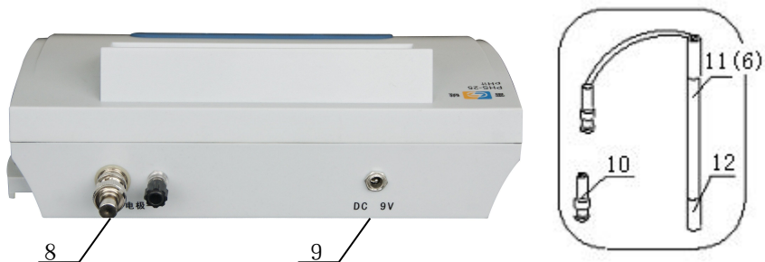
PHS-25 型 pH 计的后面板图 (图 2)
