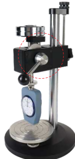
凸轮式加卸荷使测试过程更平稳
