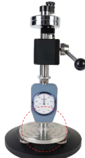
试样支撑台可以通过螺钉调平
