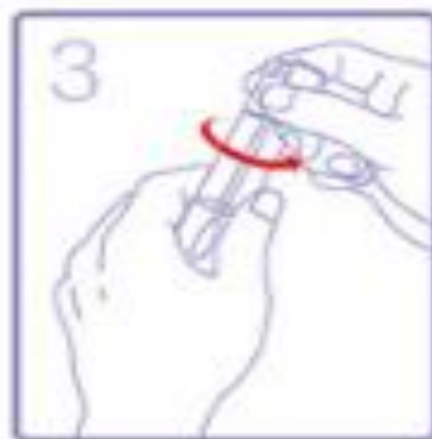
以逆时针方向打开泵盖
